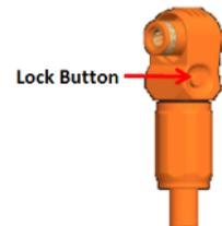
Für Netzkabel werden wasserdichte Stecker verwendet. Zum Abziehen des Netzkabelsteckers muss die Sperrtaste gedrückt werden.
