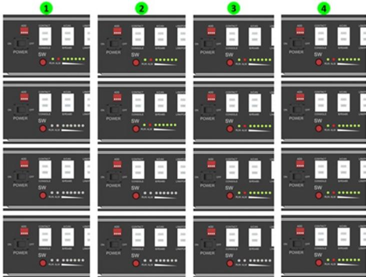
**Leuchten alle Batterie-LEDs auf und gehen dann wieder aus, so bedeutet dies, dass das Batteriesystem in Ordnung ist und funktioniert.**
