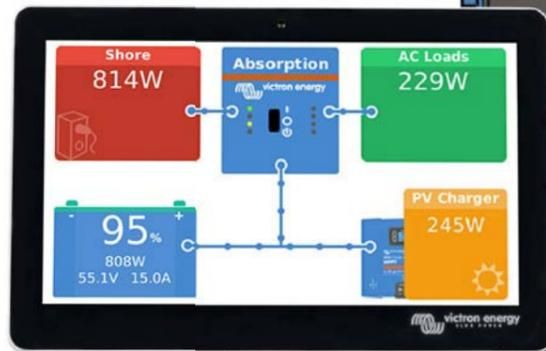
Cerbo GX: ermöglicht die VRM-Fernüberwachung, optimiert die Leistung des Systems und startet/stopt den Generator, um die Batterien bei Bedarf zu laden. Das GX-Touch-Display gibt einen sofortigen Überblick über das System und ermöglicht es dem Installateur, die Systemeinstellungen zu ändern. Die Venus-Betriebssystemsoftware ermöglicht die Arbeit mit Node-Red, um detaillierte automatische Abläufe auf der Grundlage beliebiger Datenpunkte zu erstellen.
